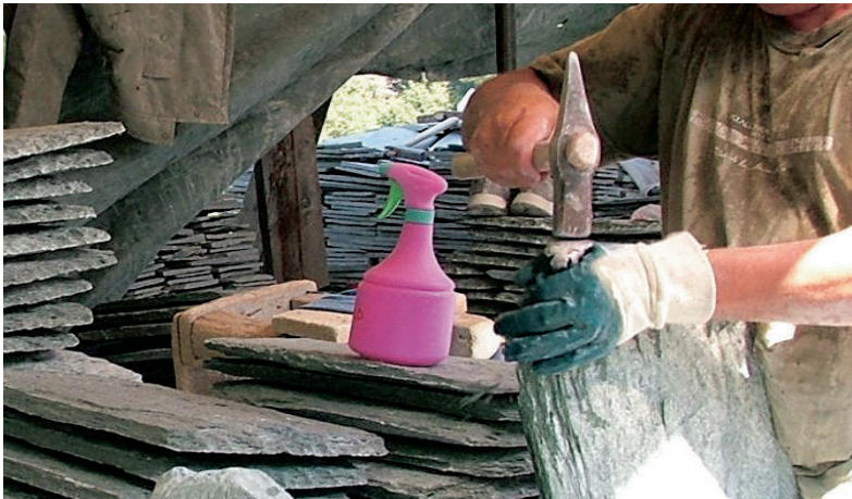
Figura 6.6 - Spacco manuale nella lavorazione del serpentinoscisto
